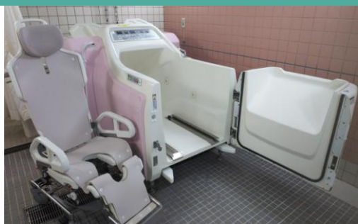
機械浴 ：椅子はリクライニング機能がついており、立位・座位が不安定な方でも入浴ができます。泡風呂機能もあります。 ※フルフラットにはなりません
